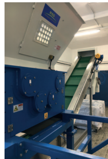
Viershaft shredder met RVS afvoerband
